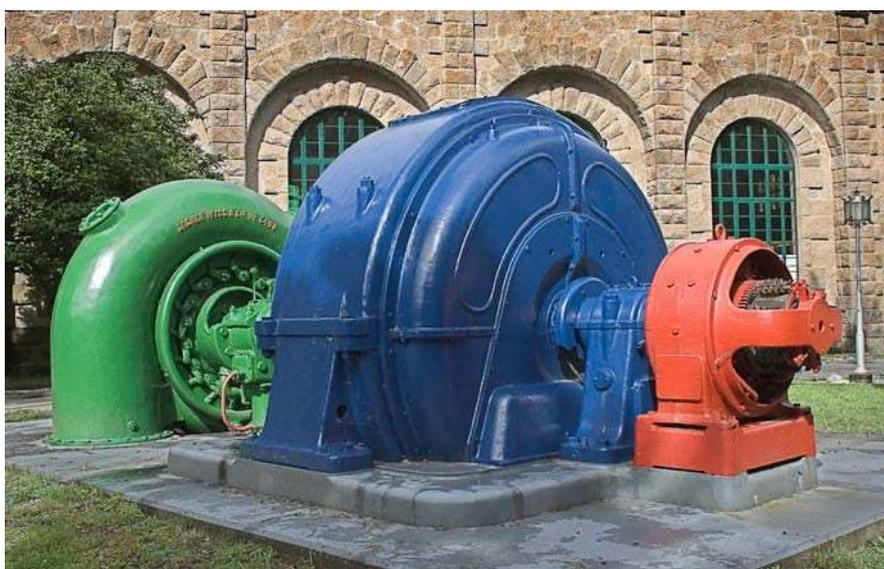
*Imagem 91: Antiga turbina e dínamo hidráulico da central eléctrica de Tambre I.*
